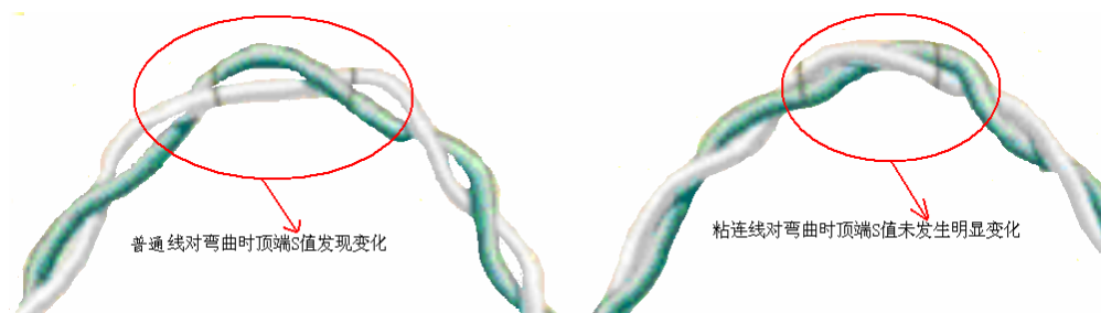
图 2 粘连线对与普通线对在弯曲时顶端 S 值的变化情况示意图
